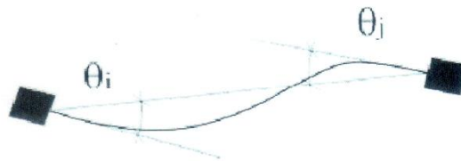
Σχήμα 4: Γωνίες στροφής χορδής σε κάθε κόμβο μέλους
